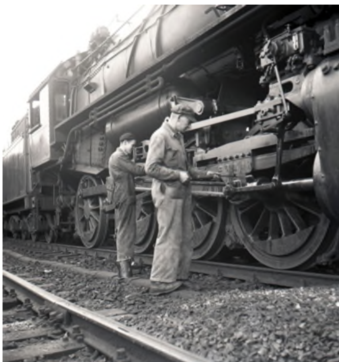
Le machiniste et le chauffeur occupés à lubrifier les bielles et les engrenages d'une locomotive à vapeur de type 29 (1D Consolidation) (Réf. Z05148)
