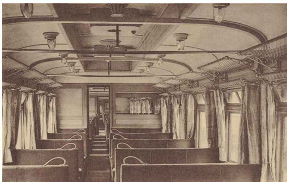
L'intérieur d'une voiture de train-radio scolaire, avec les haut-parleurs montés au plafond. (Photo : collection Jef Van Olmen)
