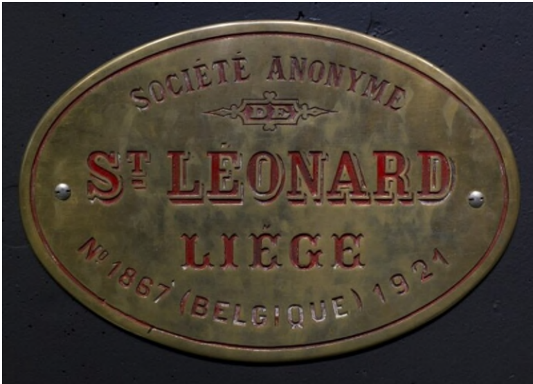
Constructeursplaat van de Ateliers de St-Léonard aangebracht op een NMBS-stoomlocomotief type 53 nr. 5358, dan 53.058 (Ref. 2234)
