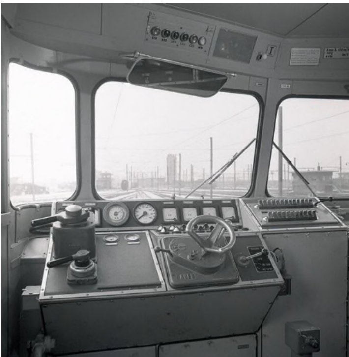
Stuurpost van een elektrische locomotief reeks 15, in zijn oorspronkelijke uitvoering (Ref. Z06447)
