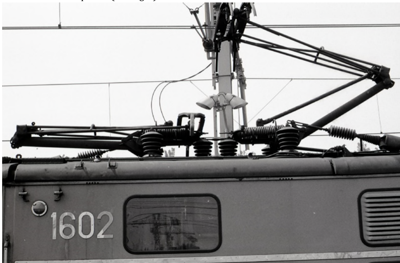
Pantografen voor het Duitse (links) en Belgische (rechts) net (Ref. MZ00967)
