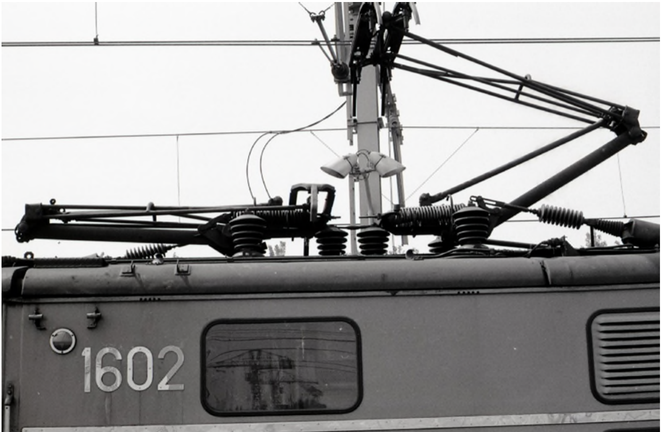
Pantografen voor het Duitse (links) en Belgische (rechts) net (Ref. MZ00967)
