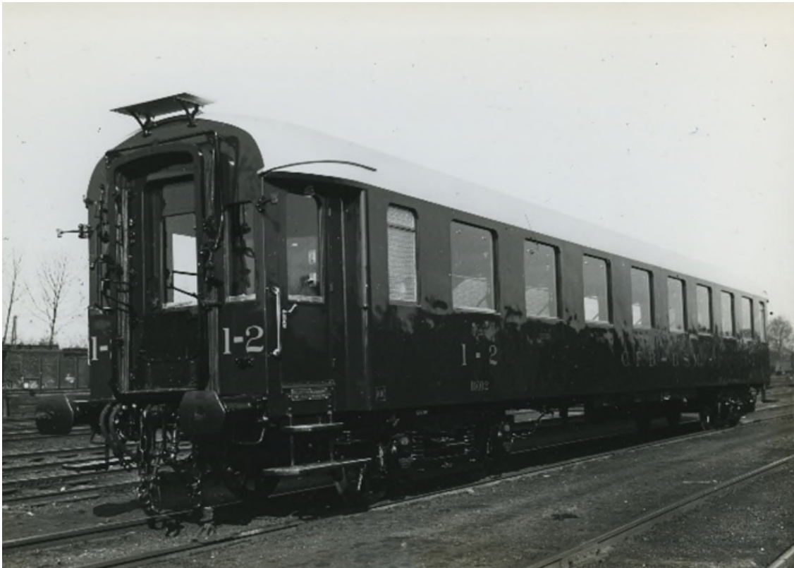
I 1-rijtuig 10102 met volledig gelaste kast (Ref. Z05845)
