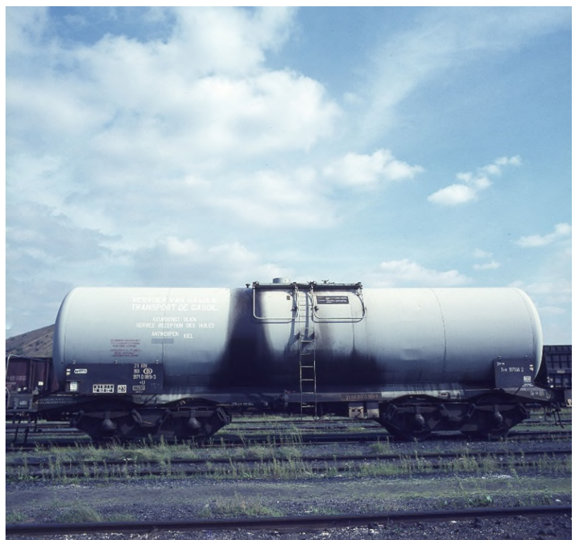
Ketelwagen met draaistellen, geleverd door les Usines de Braine-le-Comte in 1964 (Ref. Z08318C)
