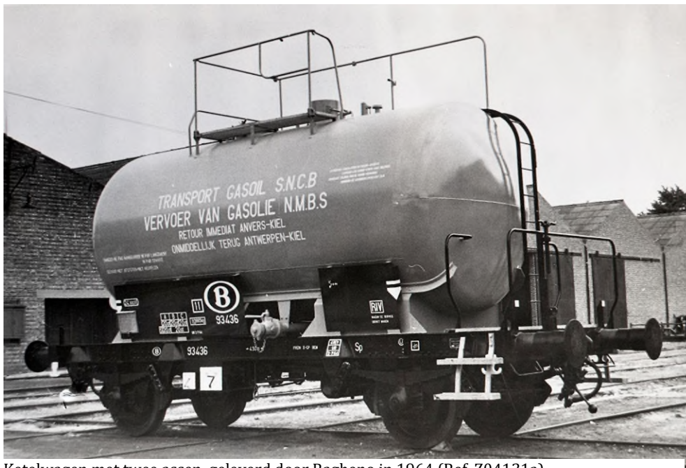
Ketelwagen met twee assen, geleverd door Ragheno in 1964 (Ref. Z04131a)
