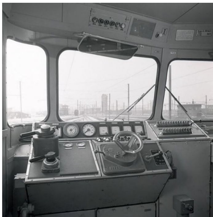
Poste de conduite d'une locomotive électrique de la série 15, dans sa version d'origine (Réf. Z06447)
