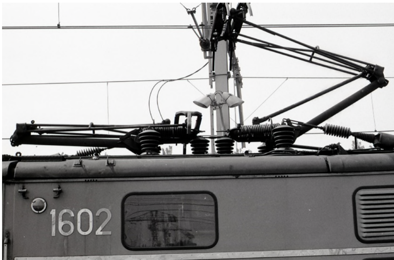
Pantographes des réseaux allemand (à gauche) et belge (à droite) (réf. MZ00967)
