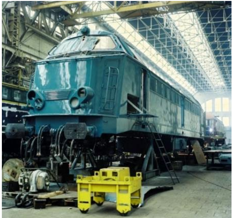
Ombouwing van diesellocomotief 5001 in de Centrale Werkplaats Salzinnes (Réf. K00224)
