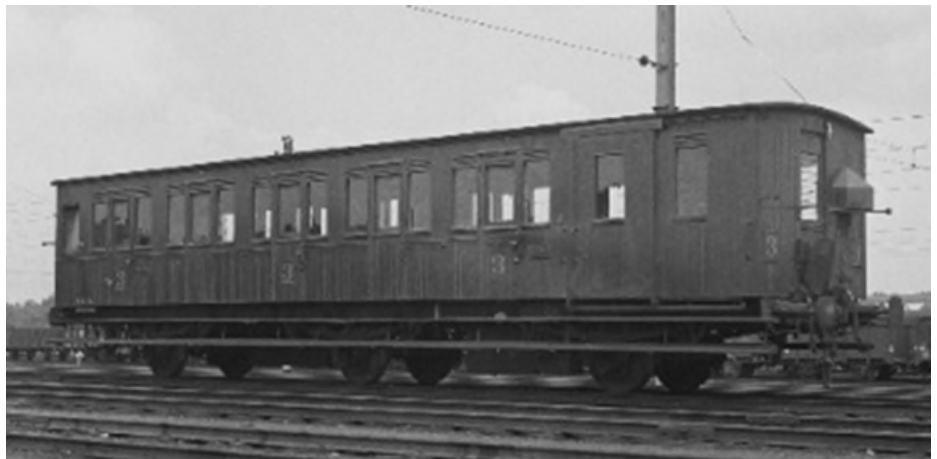
Rijtuig 91212 na verbouwing tot CD-rijtuig (Ref. Z05899a)
