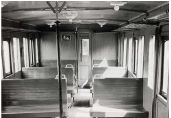
Interieur van een verbouwd rijtuig derde klas met houten banken en middengang (Ref. Z05900a)
