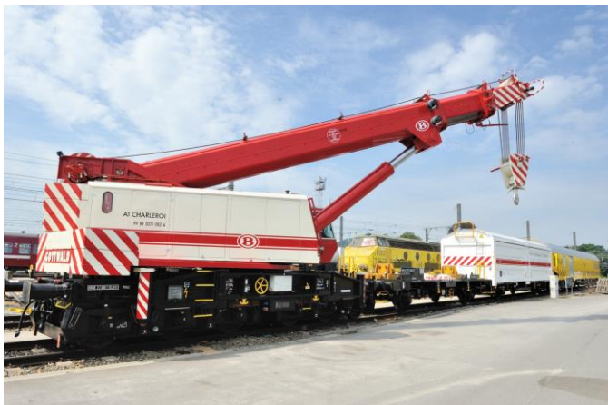
Grue ferroviaire moderne de type Gottwald avec une capacité de levage de 100 tonnes (Réf : D3886-13)
