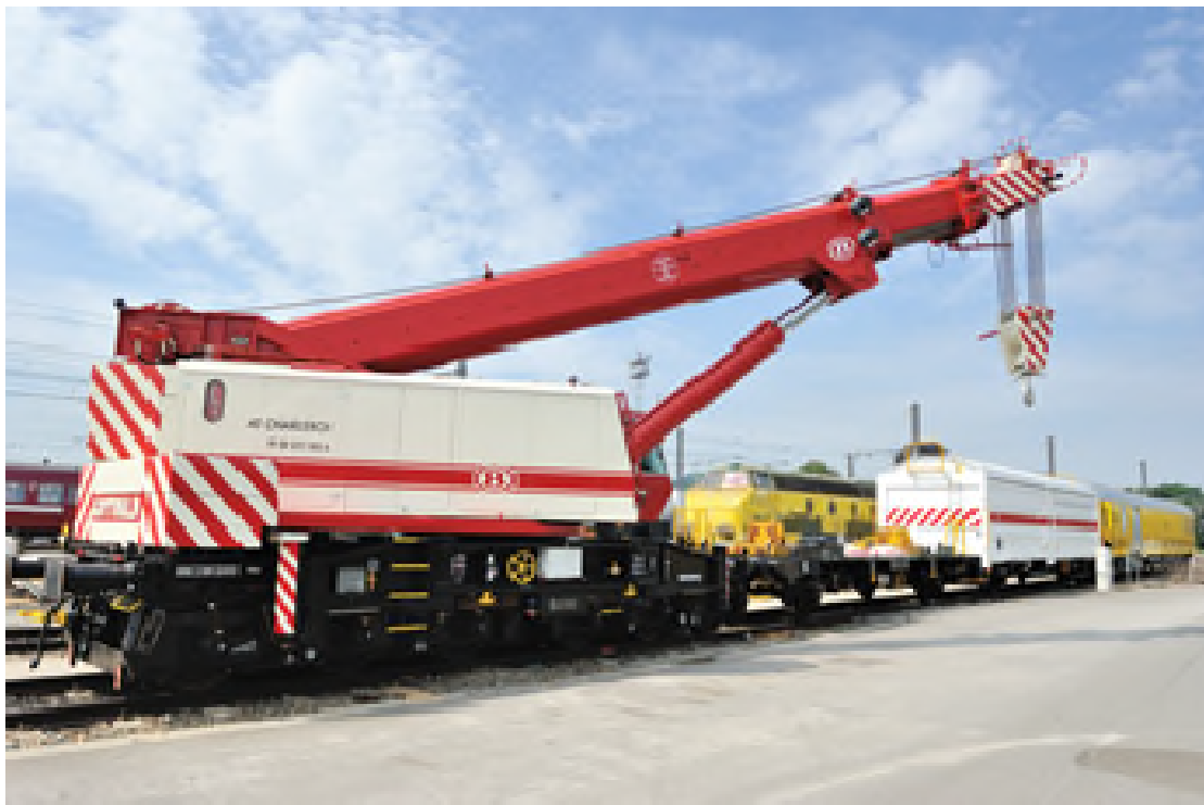
Grue ferroviaire moderne de type Gottwal avec une capacité de levage de 100 tonnes (Réf : D3886-13)
