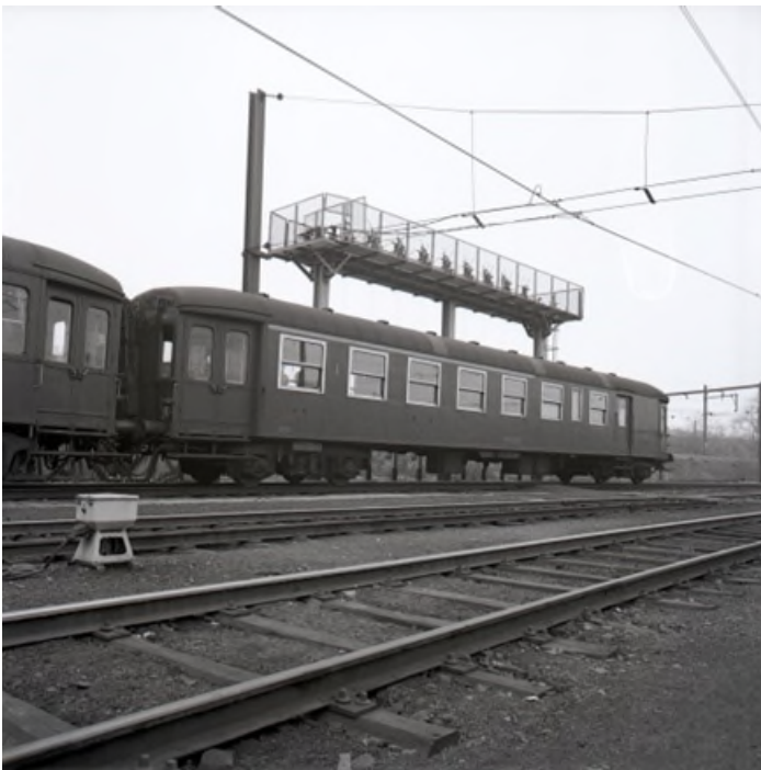
K 1-rijtuig ADR uit reeks 28901-28915 met aluminium ramen en Schlieren draaistellen (Ref. Z06098)
