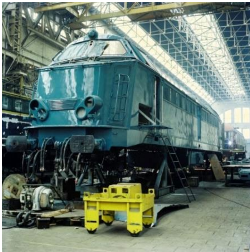
Transformation de la locomotive diesel 5001 à l'atelier de Salzennes (Réf. K00224)
