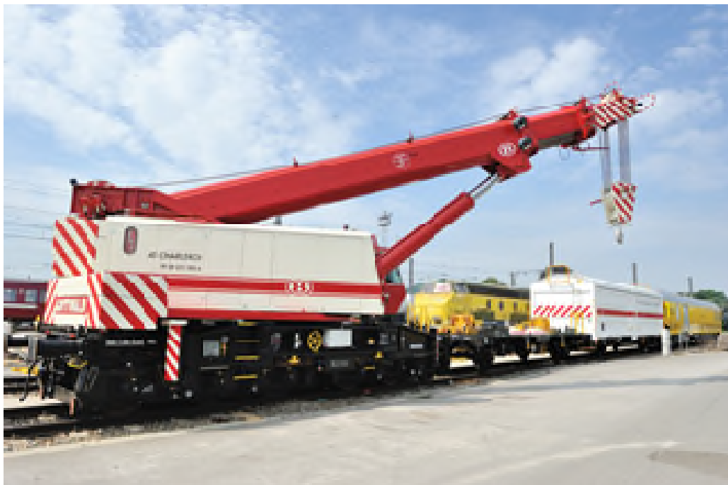
Moderne spoorkraan type Gottwald met een hijsvermogen van 100 ton. (Ref: D3886-13)
