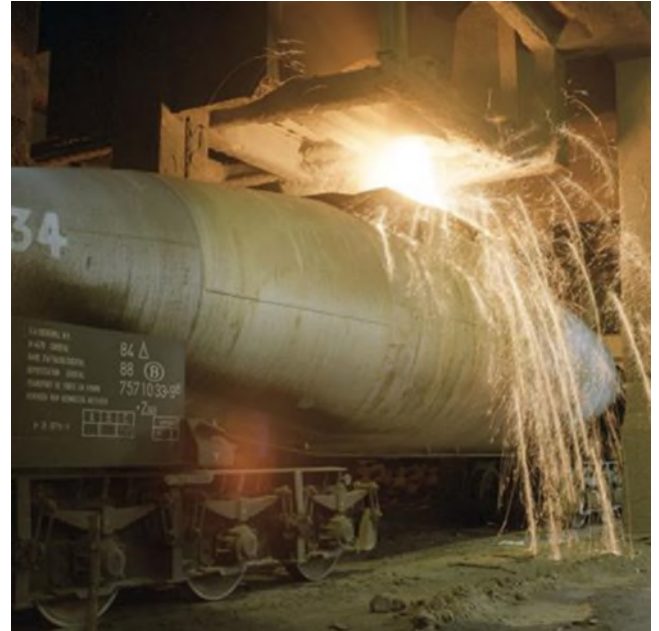
Vullen van een torpedowagen met vloeibaar ruwijzer (Ref. D0470-01)
