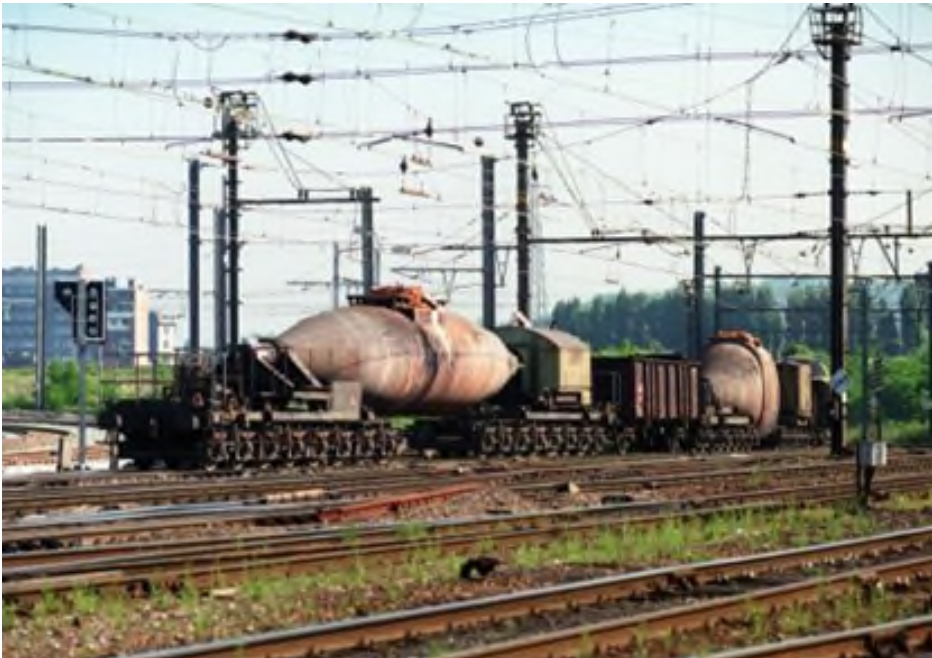
Torpedowagens tijdens een gietijzertransport te Kinkempois (Ref. D0939-04)
