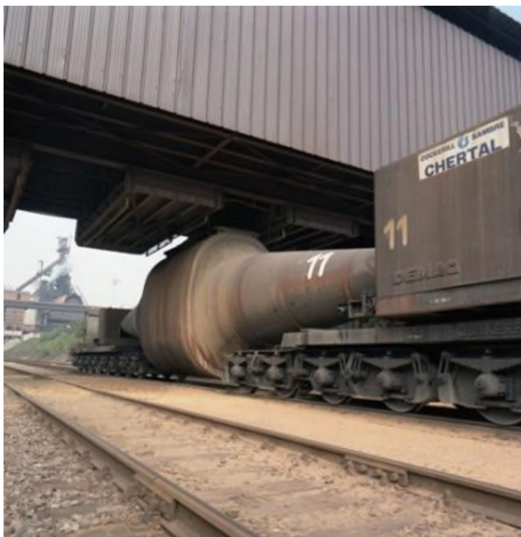
Torpedowagen in een goederentrein te Kinkempois (Ref. D0423_01)
