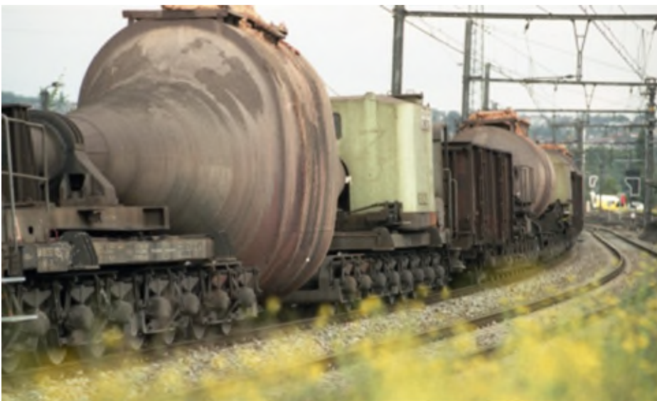
Goederentrein met vloeibaar gietijzer bij Kinkempois (Ref. D1135-13a)
