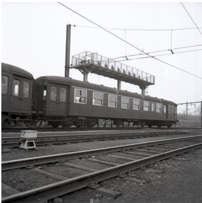
Voiture K 1 ADR de la série 28901-28915 équipée de châssis en aluminium et de bogies Schlieren (Réf. Z06098).
