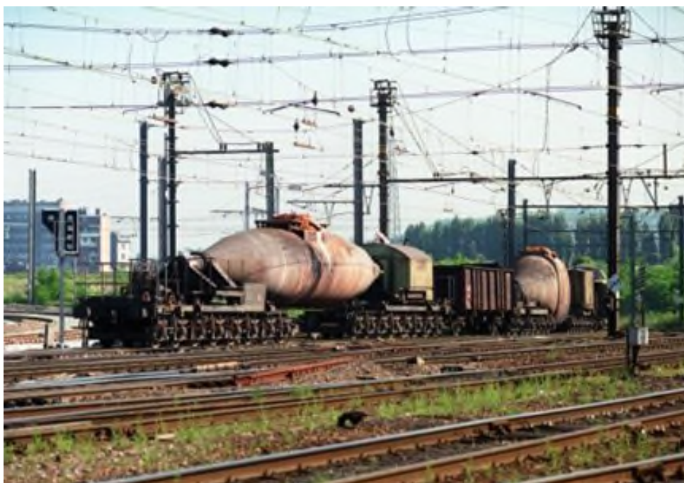
Wagons-torpille lors du transport de fonte à Kinkempois (Réf. D0939-04)
