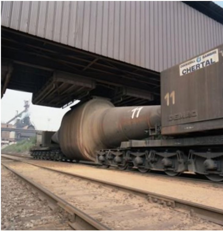
Wagon-torpille dans un train de marchandises à Kinkempois (Réf. D0423_01)
