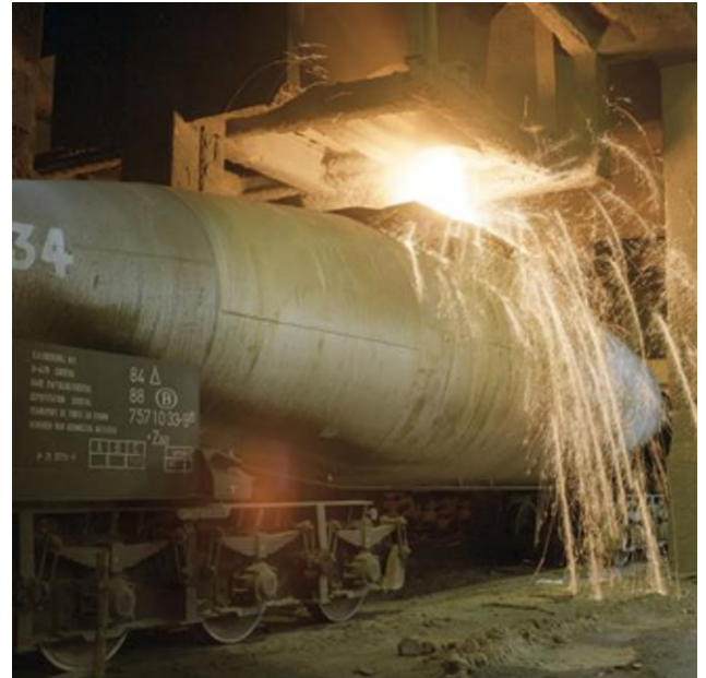
Remplissage d'un wagon-torpille avec de la fonte liquide (Réf. D0470-01)
