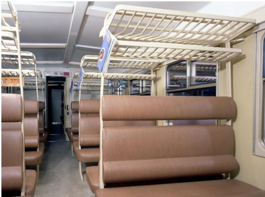
Les parois d'about sont en mélaminé de couleur ivoire et les parois longitudinales ainsi que les portes sont en mélaminé de couleur topaze. Les banquettes disposées en configuration 2+3 sont recouvertes de simicuir marron. Les porte-bagages sont placés au-dessus des banquettes et les fenêtres peuvent être occultées par des stores gris/blancs.
