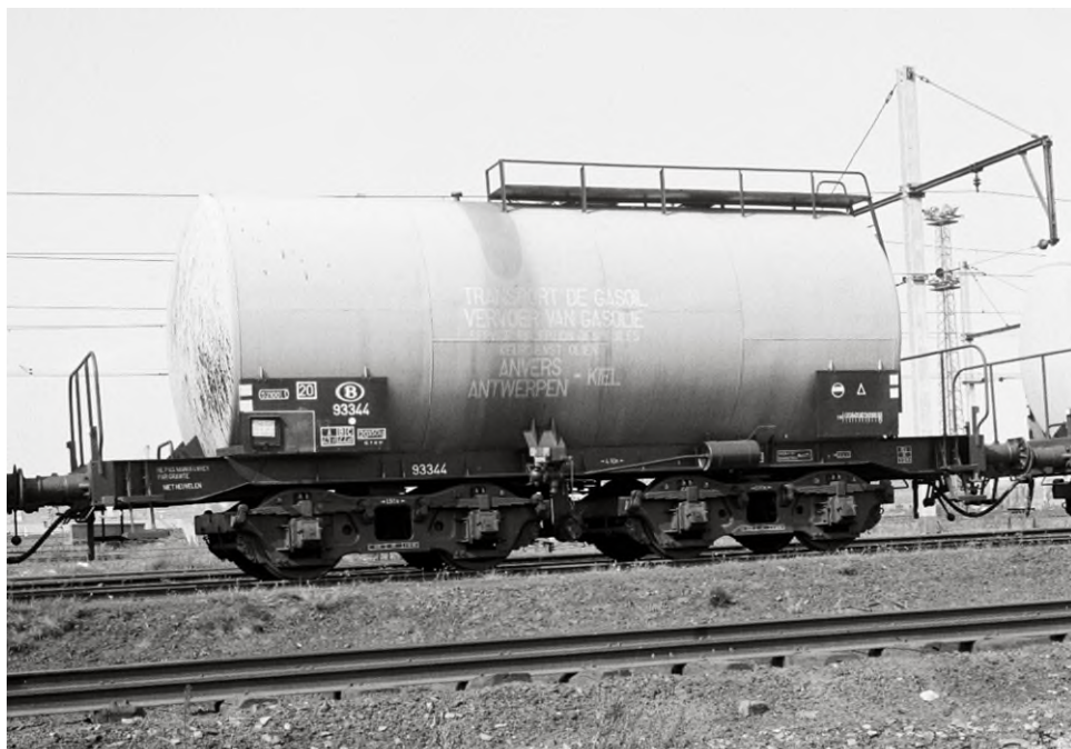
Wagons construits sur base de la transformation de tenders de 32 m 3 , réalisée en 1960.(Réf. Z03326)
