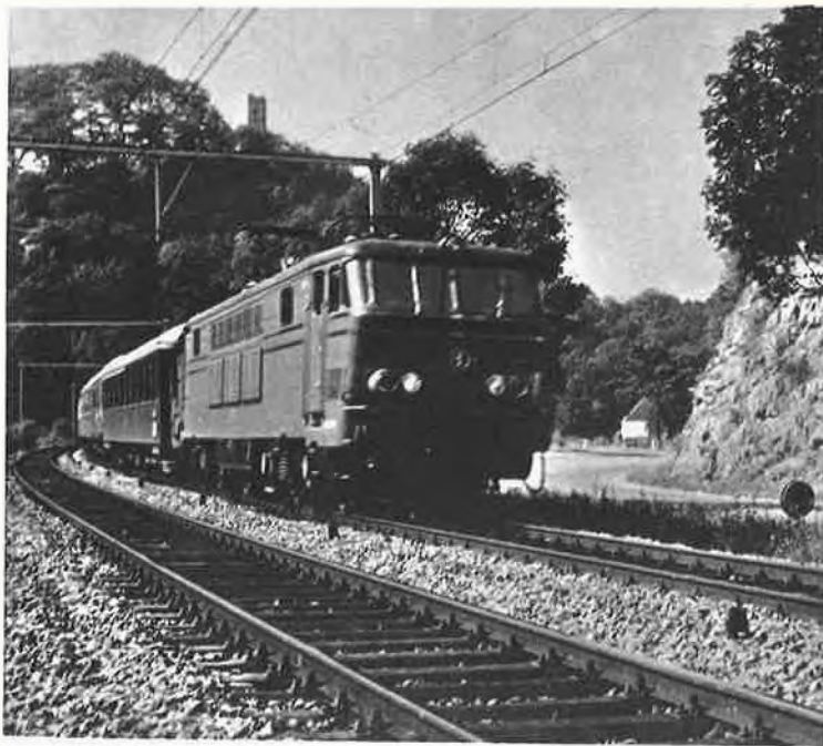
Fig. 4. — Un train Cologne - Bruxelles, remorqué par une locomotive quadricourant type 160.
