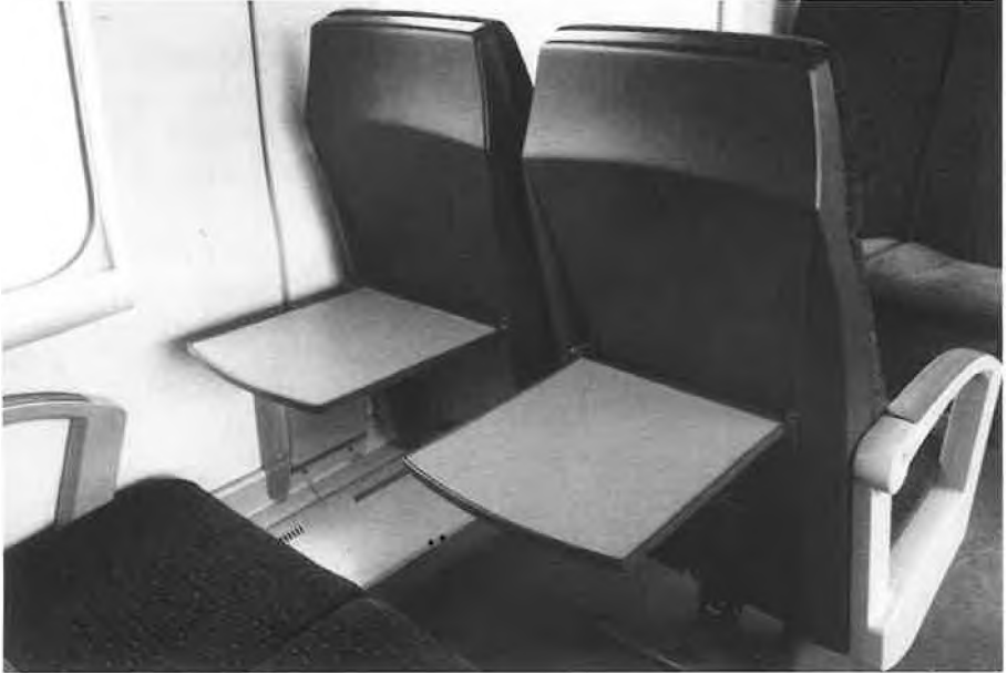
Détail de l'aménagement intérieur d'une voiture I11 de 2ème classe : tablette rabattable et repose-pied pour les sièges en file (photo SNCB)
