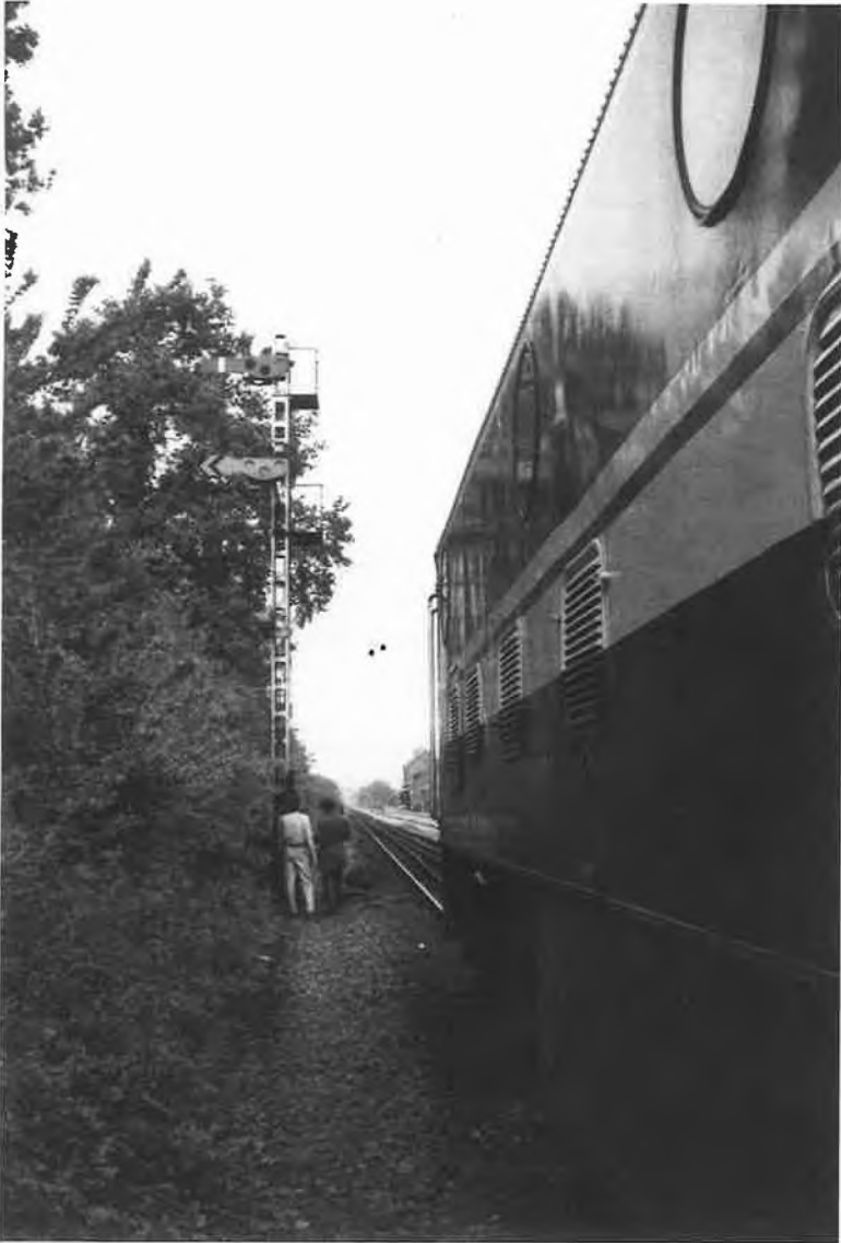
Un signal à palettes à 3 positions sur la ligne-musée Saint-Ghislain - Quiévrain, avant sa modernisation et son électrification (photo J. Ferrière, 8 mai 1993).
