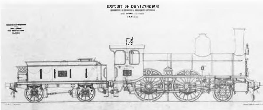
20.- Type 7 n° 177 exposée à Vienne en 1873. Tender avec nouveau dispositif de frein. Bel abri et plaque de constructeur d'apparat. Chaudière de type 2. Curieuse sablière de ligne «exotique» nichée sur le tablier, entre les couvre-roues Tubize (Doc. Tubize).
