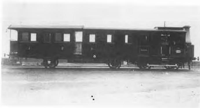
31.- Type 29, voiture à vapeur à chaudière longitudinale. Elle offre les 3 classes et un compartiment à bagages. (Coll. de Pater (Delft)).
