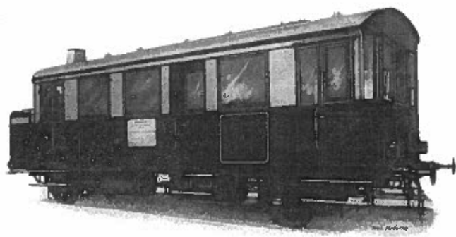
FIG. 126. — Voiture motrice électrique avec moteur à pétrole de la Société d'entreprises électriques Bergmann, à Berlin.
