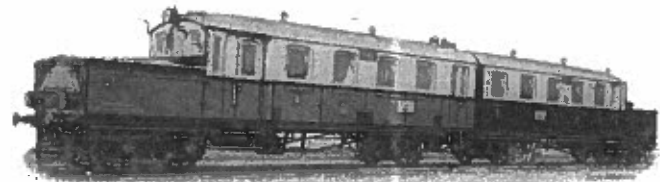
FIG. 123. — Voiture automotrice électrique à accumulateurs à 6 essieux, des chemins de fer de l'Etat prussien et du grand-duché de Hesse.
