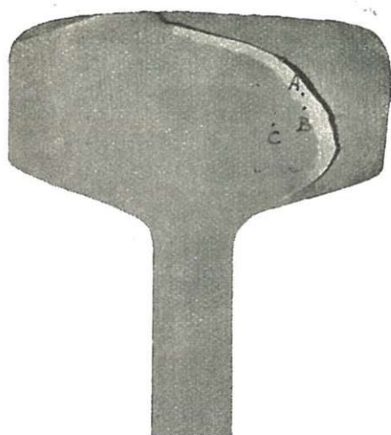
Fig. 10. — Attaque macrographique montrant la zone d'acier doux et la fêlure du rail.
