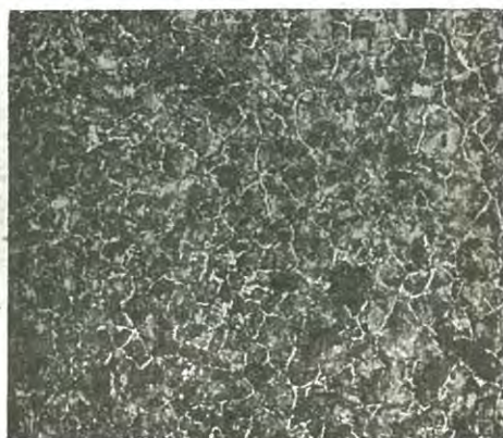
Fig. 13. — Ame. — Réseau de ferrite, de perlite et de sorbite. Fine cristallisation.
