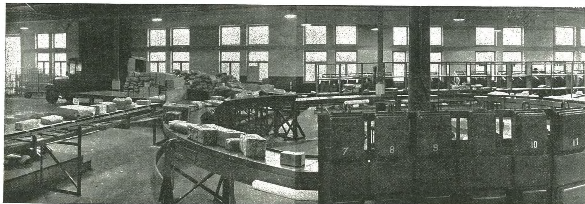
Fig. 8. — 2°) Vue panoramique de Sur ce cliché, les colis se déplacent de la gauche vers la droite. Au premier plan, le tableau blindé a commandés à distance au moyen des boutons poussoirs visibles sur la
