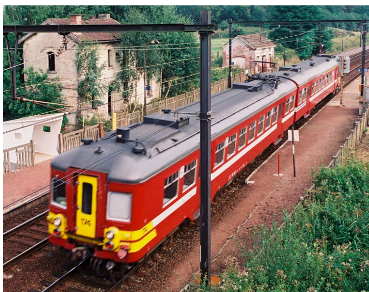
Foto 3 – Niet-gemoderniseerde klassieke tweeledige AM 66-79
