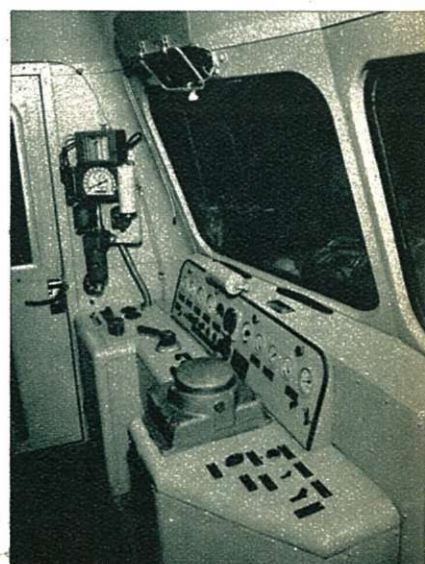
Poste de conduite de la loco type 201.
