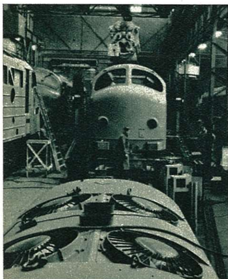
A l'avant-plan, les ventilateurs pour l'eau de refroidissement du diesel.
