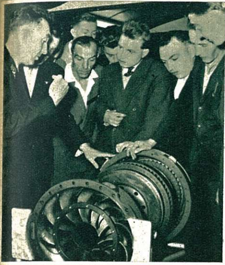
Stator van een koppeltransformator.
