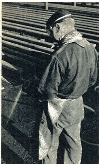
Werk der spoorstaven — Afslippen van de uiteinden der spoorstaven vóór het lassen.
