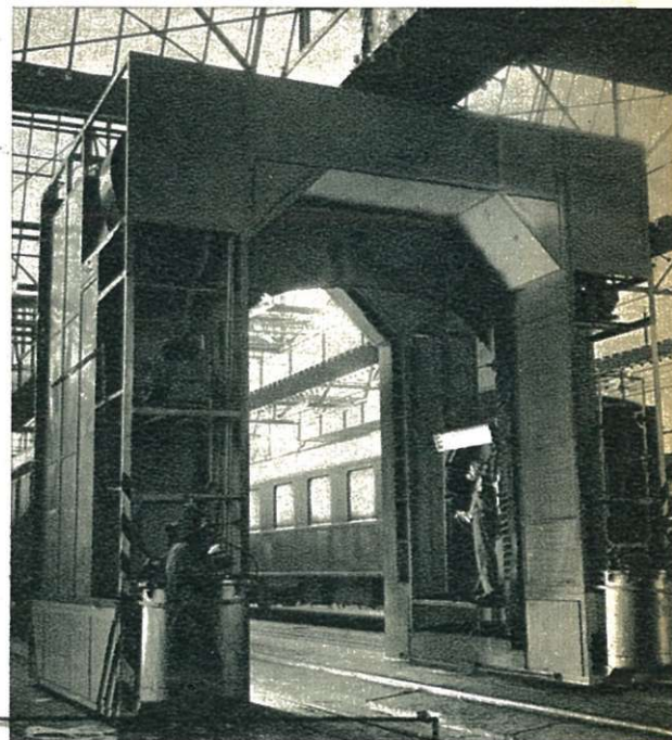
Deux peintres, protégés de vêtements spéciaux, sont prêts à commencer leur travail. On remarque les quatre réservoirs à couleur et une des deux plates-formes de travail.
