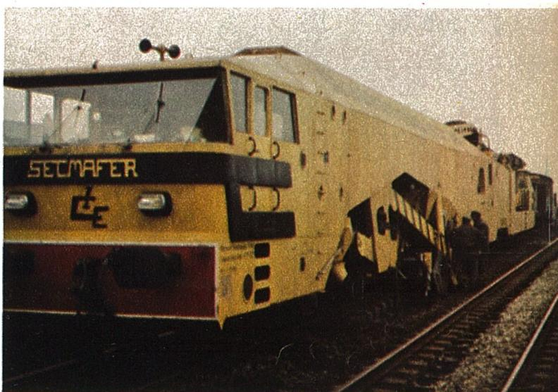
Afin de réaliser plus rapidement encore le criblage du ballast tout en réduisant les entraves à la circulation, des machines plus compliquées ont été mises en œuvre. Nous voyons ici une dégarnisseur qui réalise simultanément le dégarnissement-criблage du ballast, le réglage de la surface d'appui des traverses et le dressage de la voie. Cette machine, louée par le service de la Voie, a un avancement moyen de 300 à 350 m/heure.
