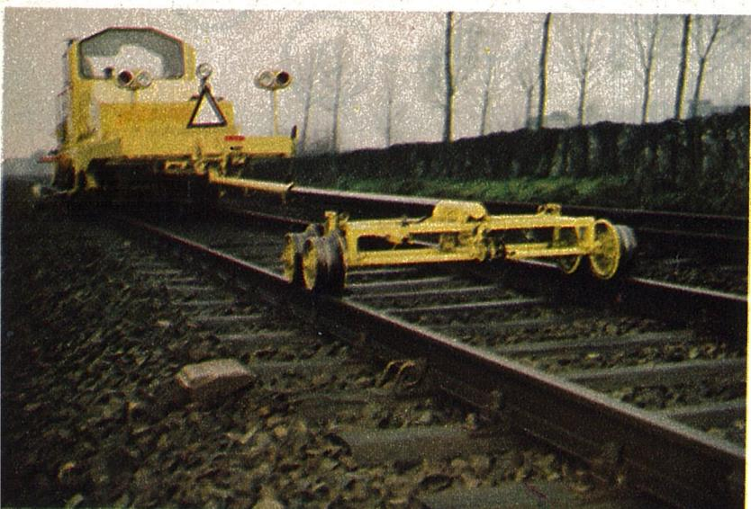
Depuis 1963, des bourreuses perfectionnées permettent de mesurer les défauts de nivellement de la voie par rapport à une ligne de référence. Ici, la ligne de référence du nivellement est obtenue par un faisceau de rayons infrarouges émis par le chariot avant. La machine bourse la traverse de manière à remettre le rail dans un plan parfait. Cette machine, normalement accompagnée de trois agents, permet un avancement de 200 à 300 m par heure.
