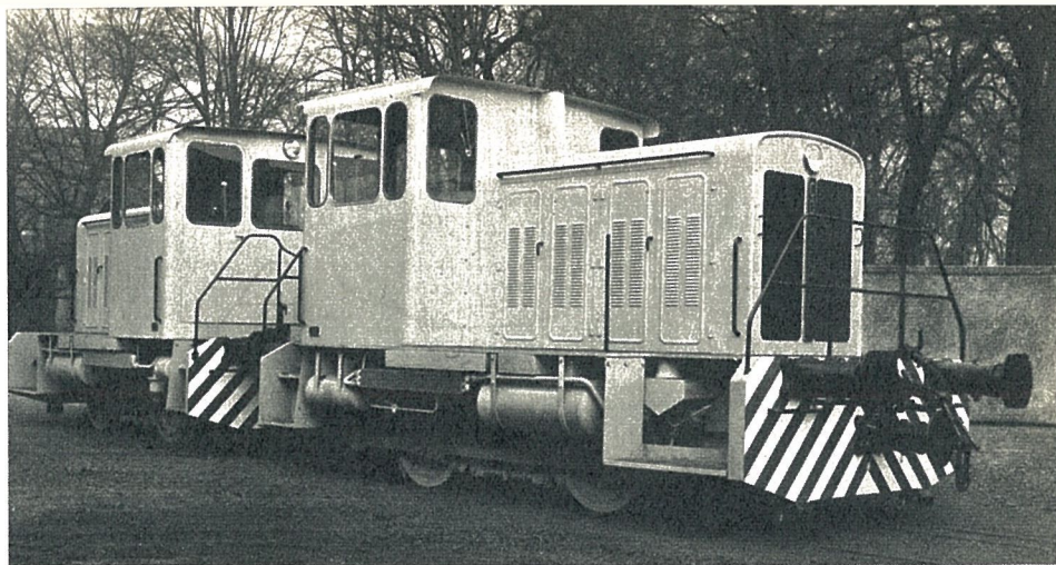
Locotracteurs de 24 t des Carrières de l'Ermitage, à Deux-Acres (Hainaut). Ces engins, de type plus ancien, sont couplés en unités doubles.
