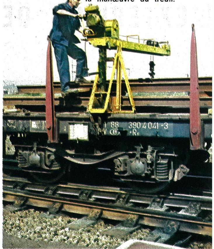
Il suffit de 2 treuils pour le rechargement de rails de 18 m de longueur. On utilise généralement 3 treuils pour recharger des rails plus longs.
