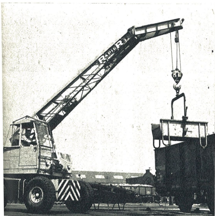
Fig. 14. Autokraan. Hefvermogen : 7,5 t.
