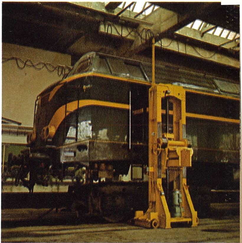
Fig. 8. Schroefvijzel van Kutruff. Hefvermogen : 25 t.
