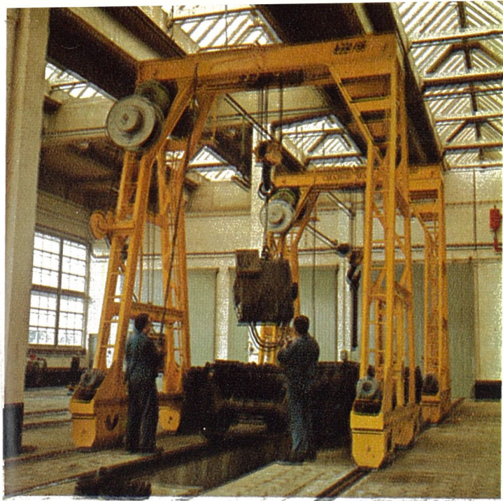
Fig. 10. Portaalkraan. Hefvermogen : 12 t.
