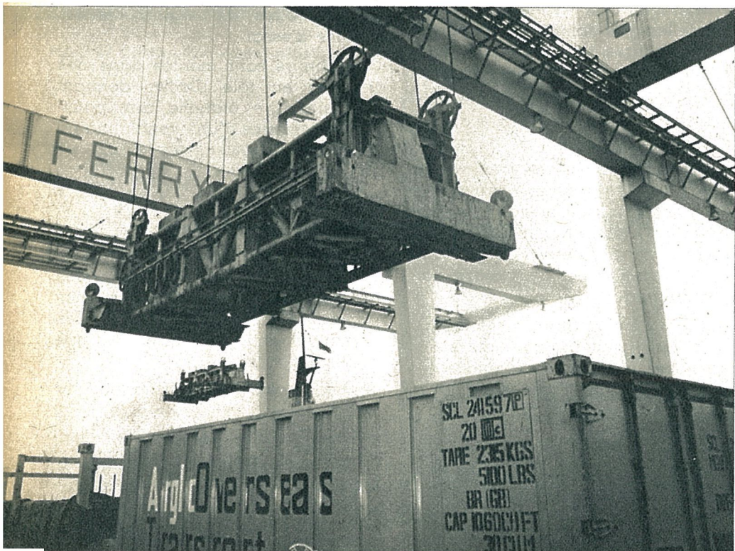
Fig. 7 — Palonnier de levage.
