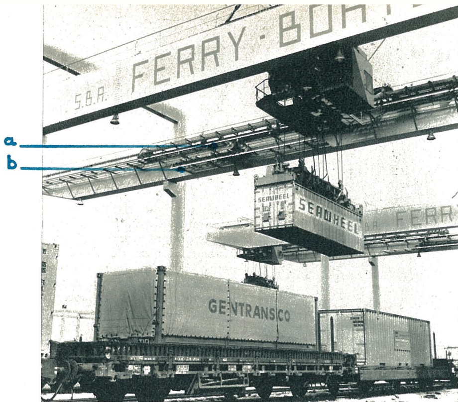
Fig. 5 — Chenilles porte-câbles d'alimentation du chariot : a) chenille principale; b) chenille auxiliaire.
