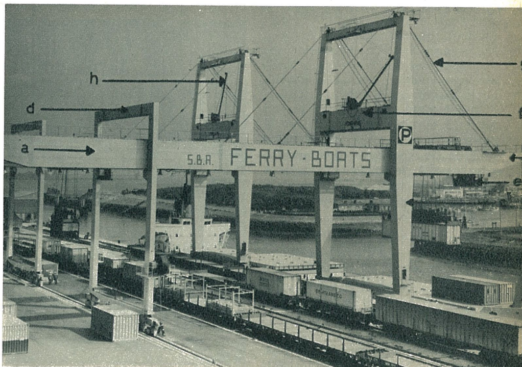
Fig. 1 — Grues à portiques : a) poutre principale ; b) avant-bec ; c) palée rigide ; d) palée articulée ; e) chariot de levage et cabine ; f) salle des machines ; g) compas ; h) grue d'entretien.
