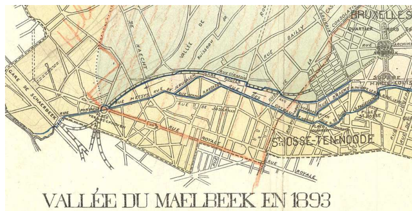
Détail du plan Vallée du Maelbeek en 1893 montrant, en bleu, le tracé du Maelbeek voûté (ACS/TP Infrastructure 186).
