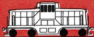
STEEPLE CAB SWITCHER : rangeerloco met centrale stuurhut die de kleine spoorwegaansluitingen, de dokken, enz. bedient.
