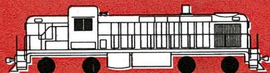
ROAD-SWITCHER : als een echt manasje-van-alles, moet zij rangeringen doen en lichte treinen slepen, maar, in veelvoudige eenheden, verzekert zij ook het slepen van zware treinen.
