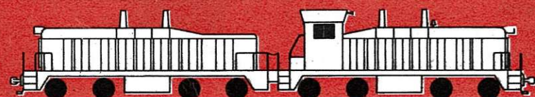
COW-AND-CALF (koe en kalf) : rangeerloco + trekelement voor sortering en rangeringen.
