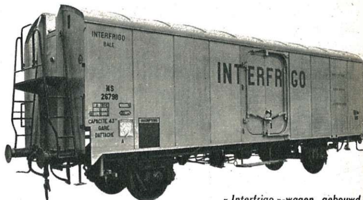
« Interfrigo »-wagen gebouwd met « sandwich »-panelen.
