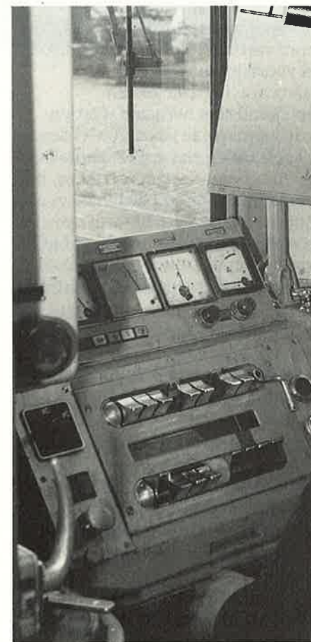
Stuurpost met verklikkerlampjes van de TBL-uitrusting
