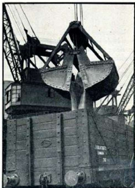
Grappin de grue transférant de l'antimoine de la cale d'un navire au rail.
