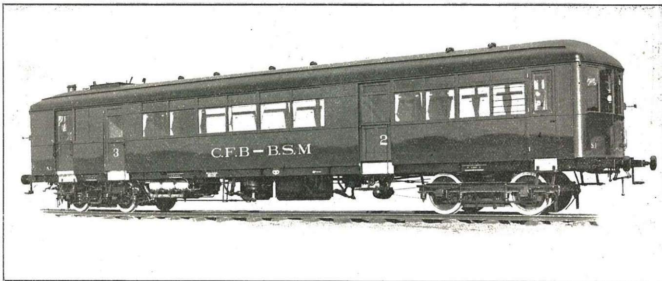
Automotrice à vapeur mixte de 2 e et 3 e classes, construite par la firme Sentinel, de Nottingham; 6 cylindres, 600 tours. En service sur le réseau belge entre Liège et Verviers, Liège et Esneux, Liège et Visé : 46 places assises en 3 e classe, 16 places assises en 2 e classe, 16 strapontins et un certain nombre de places debout.
