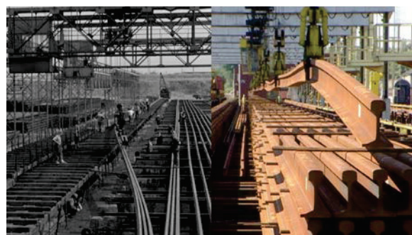
Chargement de longs rails soudés à l'atelier central de Schaerbeek
