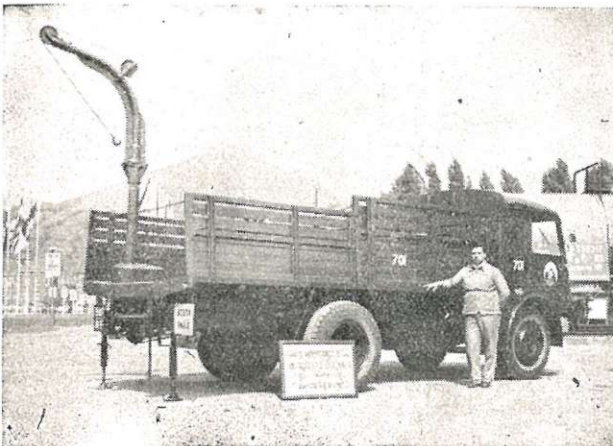
Fig. 5. — Camion avec grue pivotante utilisé par la S.N.C.F.
