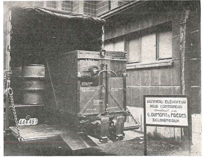
Fig. 6. — Camion S.N.C.B. avec porte-ascenseur.
