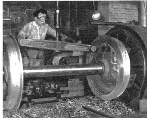
7. Het eerste afdraaien van de wielstellen.
