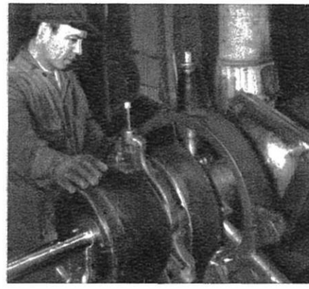
6. Het boren van de meeneemspillen.
