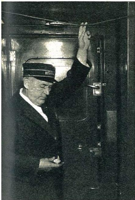
Sur le « Canadien national », quand le convoi est prêt, le chef de train donne l'ordre de départ au moyen d'un sifflet, mais d'un sifflet à vapeur, installé dans la cabine du mécanicien. Un cordon, à chaque extrémité de voiture, permet d'actionner ce sifflet : deux tractions, de trois secondes chacune, donnent le signal convenu.
