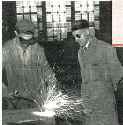
Lunettes de soudeur, coques en bakélite avec verres de teinte moyenne (travaux au chalumeau oxyacétylénique, soudage à l'arc, métallisation au pistolet-chalumeau).
