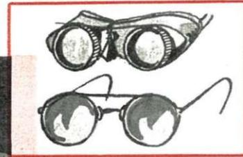
Lunettes à verres teintés (contrôle des soudures au chalumeau, soudage du cuivre au chalumeau).
