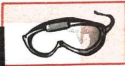
Lunettes antipoussières et antiacide (travaux aux accumulateurs, manutention d'acides ou d'autres produits corrosifs, manutention de briquettes et cendrées, désherbage, nettoyage au jet d'air comprimé, travaux au-dessus de la tête).
