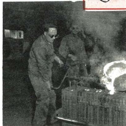
Lunettes à verres colorés, monture métallique renforcée et protection latérale (travaux de coulée de métal en fonderie, soudage aux points de pièces métalliques, travaux aux feux de forge et au marteau-pilon).
